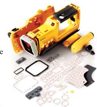
Dette vandtætte videokamera er samlet med udstanset stykker af VHB tape. Tapen giver en effektiv tætning og en sikker sammenføjning.
