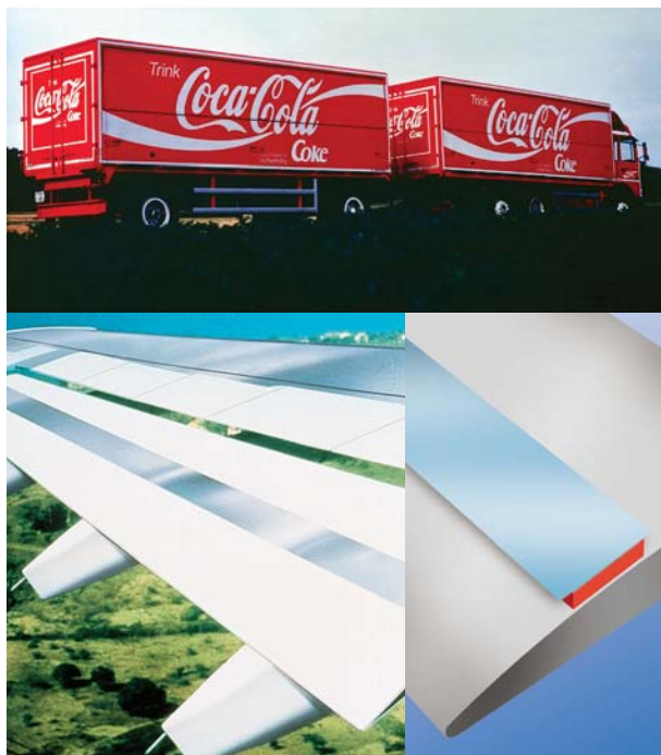
3M VHB 9473 Tape giver en sikker sammenføjning af rustfrie stålprofiler mod vingeflapperne af aluminium, og det er på trods af store temperaturforskelle mellem høje jordtemperaturer og minus grader i luften (+65 °C til -40 °C).
