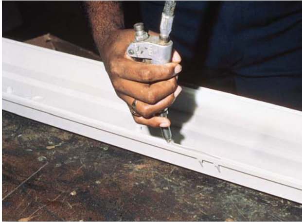
For at forhindre at fugt trænger igennem et lysskilt påføres lim på gummipakningerne med en trykluftspistol.
